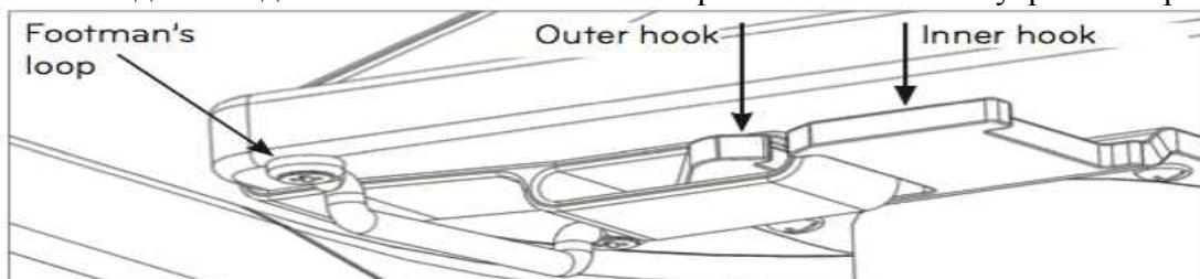
Рисунок С: Платформа для ног, вид снизу
